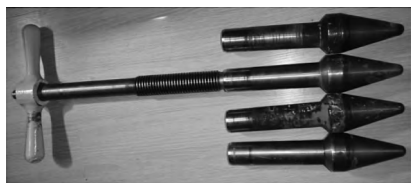
图2 断裂失效的阀杆
